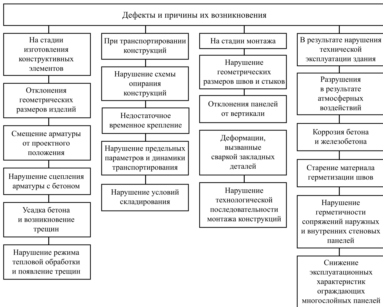
Рис. 3.1. Классификация дефектов панельных зданий первых массовых серий
