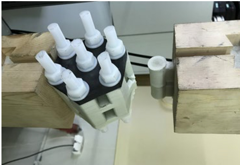
Рис. 4.25. Узел после испытания на разрыв. Автор фото Д. А. Животов, 2019 г.
