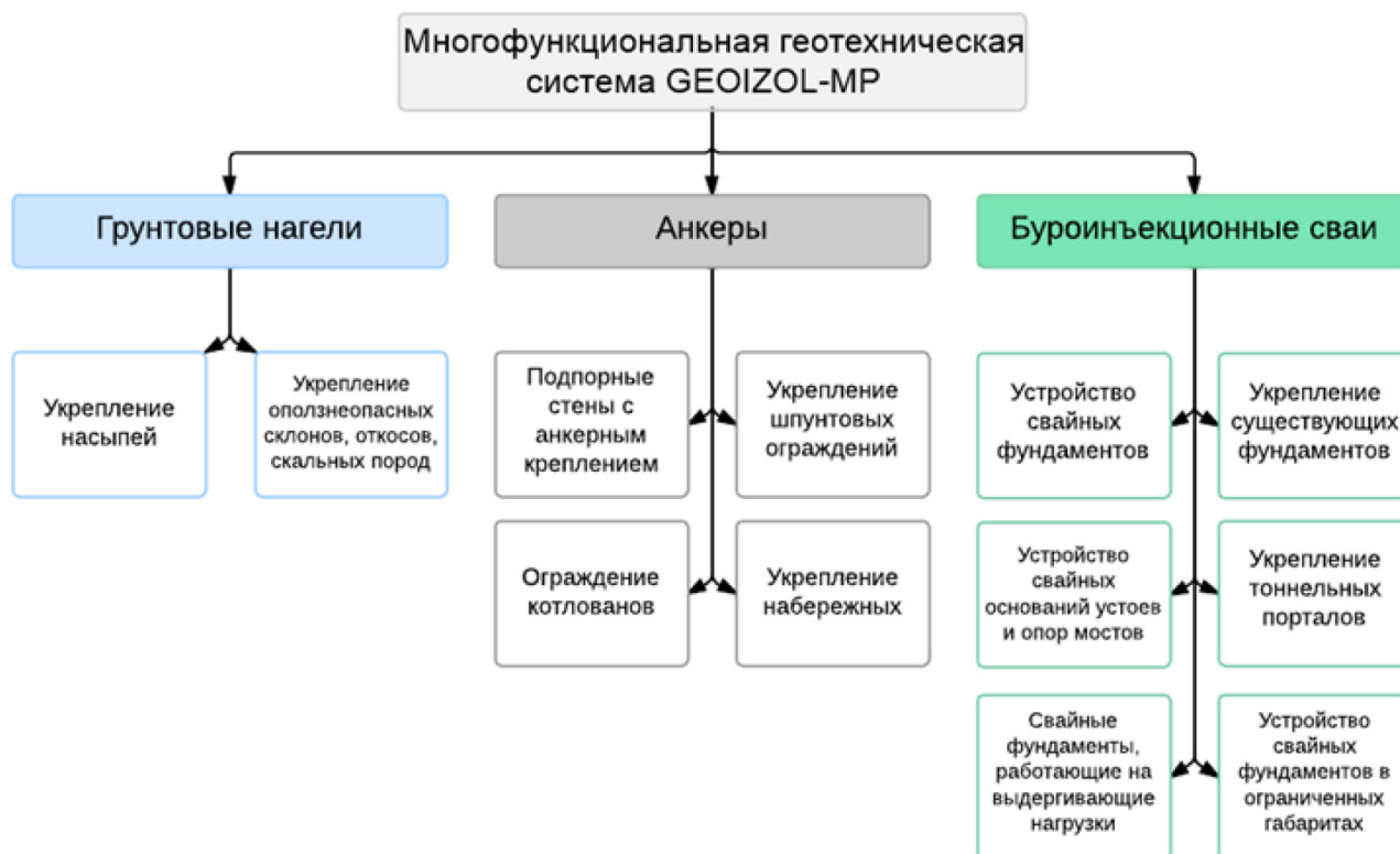
Рис. 3.45. Области применения многофункциональной геотехнической системы GEOIZOL-MP
