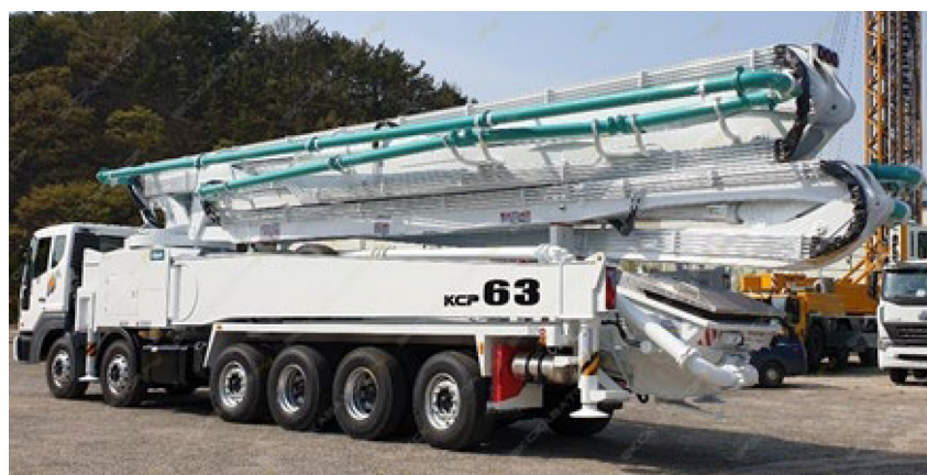
Рис. 2.41. Автобетононасос Daewoo Novus SE (производитель Daewoo, Южная Корея) с высотой подъема бетонной смеси 60,3 м. Стрела 6-секционная, Z-образная схема складывания, концевой шланг 3,5 м, фото с портала Trucks Portal https://zen.yandex.ru/media/id/5ed9ffdbb4cae34090598ea6/avtobetononasos-daewoo-novus-63-metra-5f6cae5449d076856460c46
