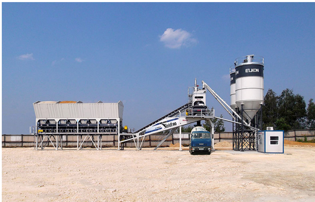
Рис. 2.50. Бетонный завод QUICK MASTER 90. Производительность 75–80 м 3 в час. Время монтажа – семь дней. Фото предоставлено компанией ООО «ЭЛКОН», 2020 г. https://www.elkon.ru/plants/quick_master/90
